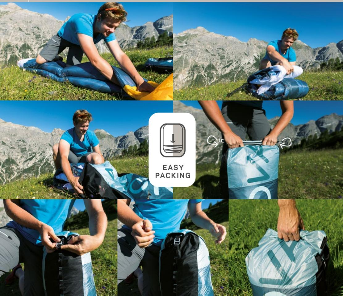
Nous conseillons de plier votre parapente de manière classique; aligner les cellules au bord d'attaque puis le reste de la voile cellule par cellule ensuite plier la voile en accordéon plutôt que de la rouler. Cela améliorera le confort au portage. Veillez à éviter de plier les joncs du bord d'attaque. Cette méthode simple de pliage est rendue possible grâce au choix des matériaux utilisés.
