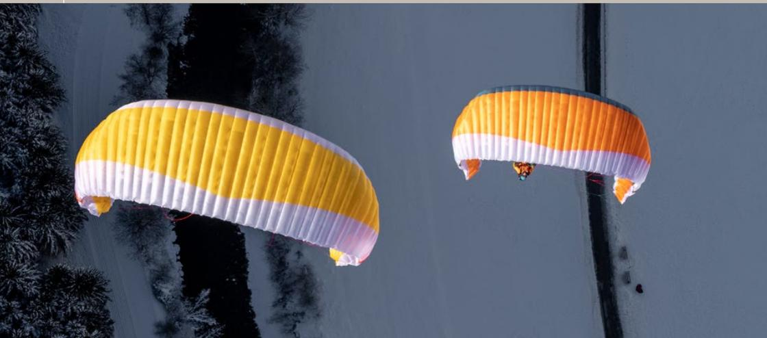
de transition décrite, c'est à dire de la plongée de l'aile face sol. En ce moment, le pilote est poussé vers l'extérieur dans son harnais. Le pilote doit relâcher la pression pour éviter que l'aile se verrouille dans la spirale.
